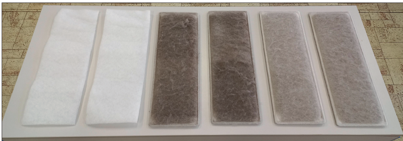
▲ Obr. 5 ● Filtry (zleva): nepoužité; na přívodu venkovního vzduchu; na odvodu odpadního vzduchu
